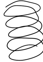
$$\vec{v} = \frac{d\vec{r}}{dt} = \dot{R}\vec{e}_R + R\dot{\phi}\vec{e}_\phi + \dot{z}\vec{k} = b\omega\vec{e}_\phi + c\vec{k}$$
