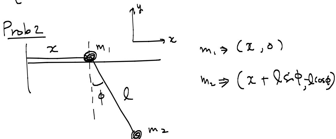
$$\vec{v}_1 = (\dot{x}, \dot{\phi}), \quad \vec{v}_2 = (\dot{x} + l_1 \dot{\phi} \cos \phi, l_1 \dot{\phi} \sin \phi)$$
